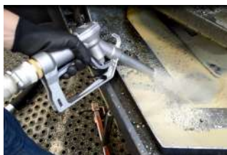
Sistema di scarico liquidi ad inversione di flusso (100 lt/min) Flux inversion liquids discharge system (100lt/min)
